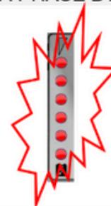
\*ATTENTION : Si tension chute brutalement en dessous de 11 volts, le système se coupe au bout de 15 secondes (En 12 volts comme en 24 volts). Ce symptôme est révélateur d'une batterie défectueuse ou usagée.
